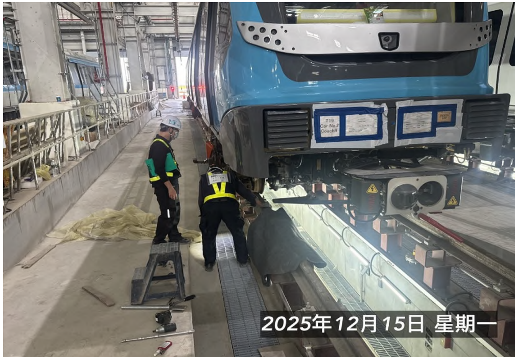
圖3. 三鶯線-電聯車T19車-整流罩調整作業
