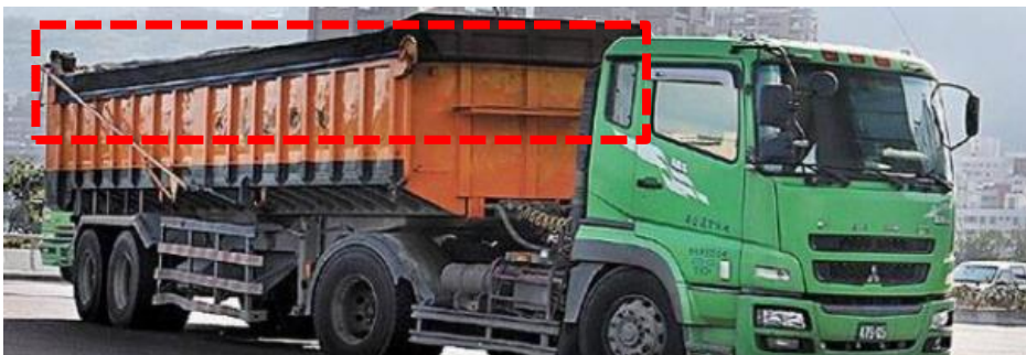
運土時以防塵布覆蓋車輛貨廂
