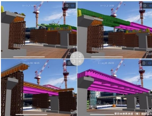
圖六 BIM 模擬機具進場方式與結構安裝進程。
