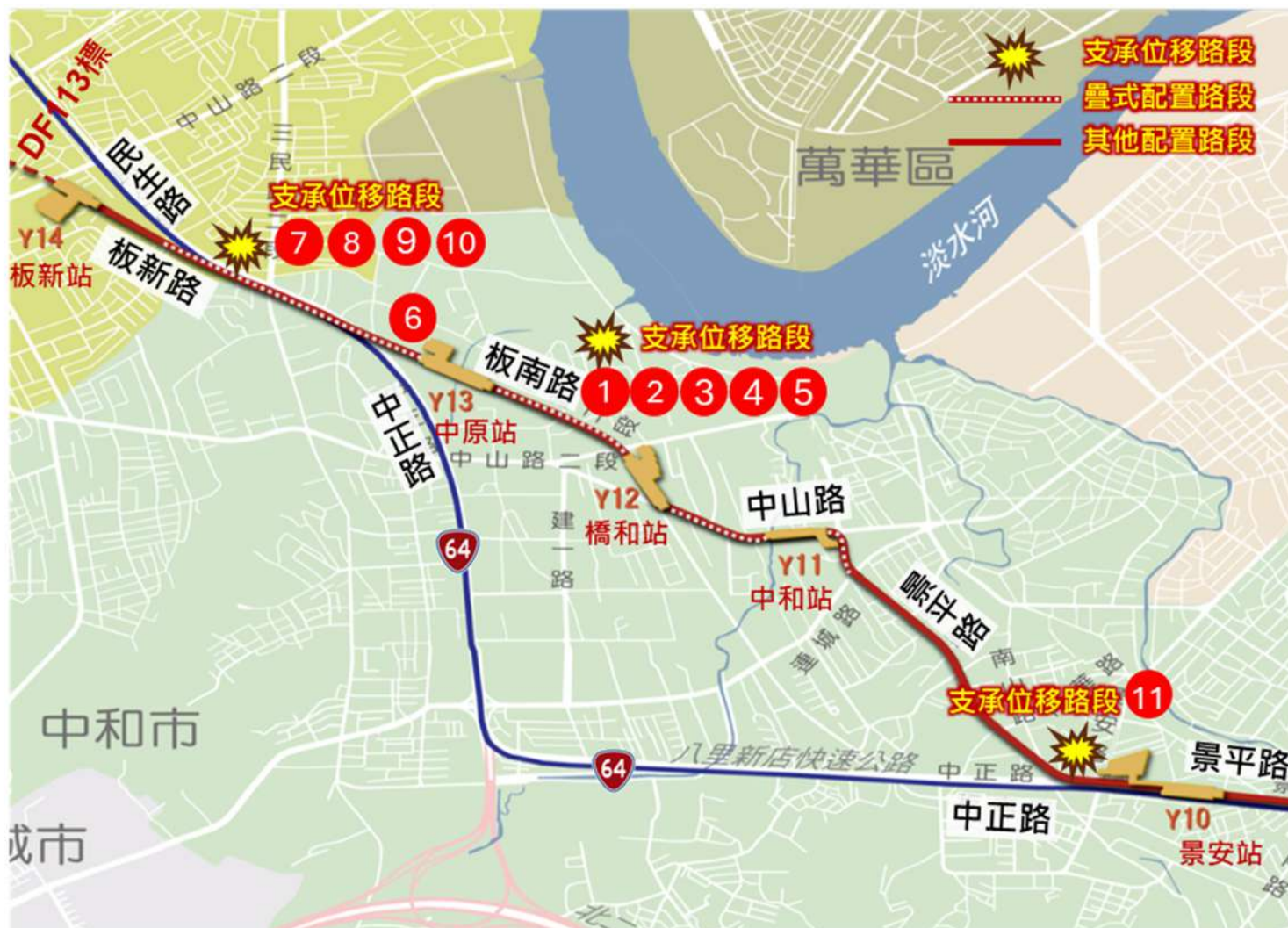
圖 2.4-2 新北環狀線橋梁受損位置
