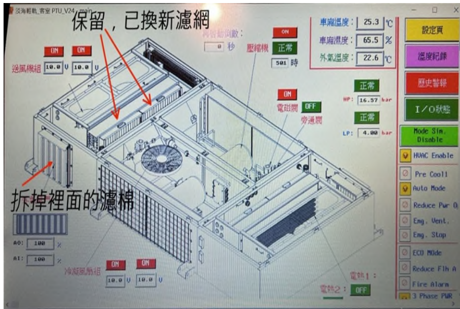
圖 14、取消外氣風門濾網(濾棉)示意圖
