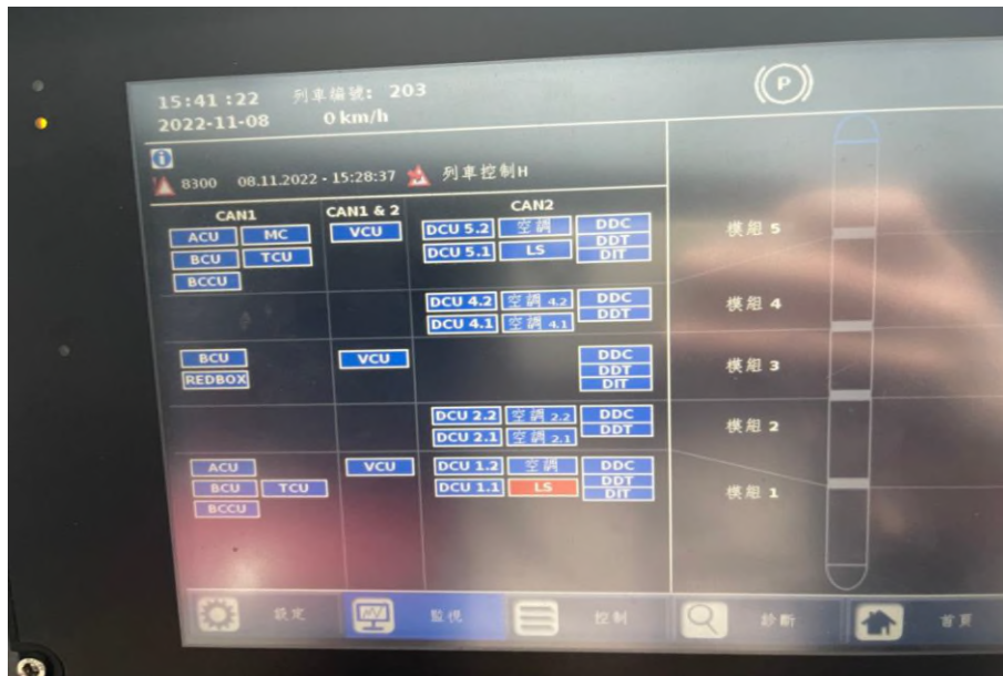
圖 6、CMS 顯示 CAN BUS 內設備異常
