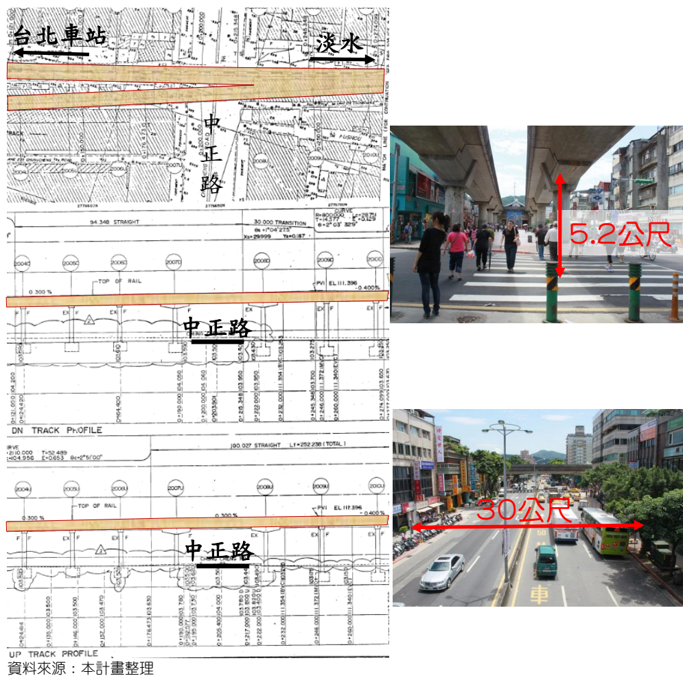
圖 7.3-47 捷運淡水線高架橋樑底高程資料
