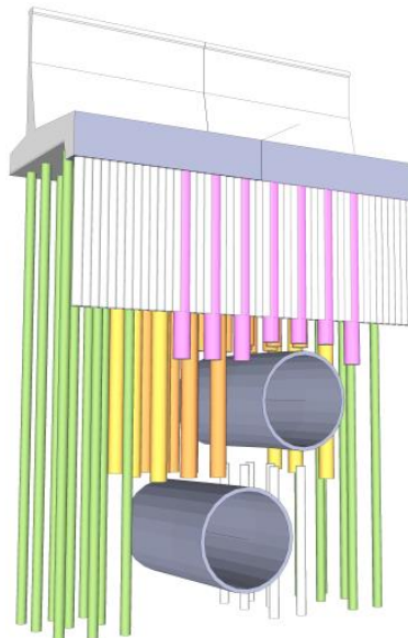
圖 7.3-22 破堤除樁法完成後潛盾隧道穿越示意圖
