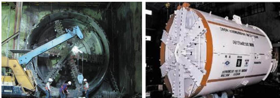
圖 7.3-13 捷運文湖線 CB420 標穿越松山機場中折式潛盾機
