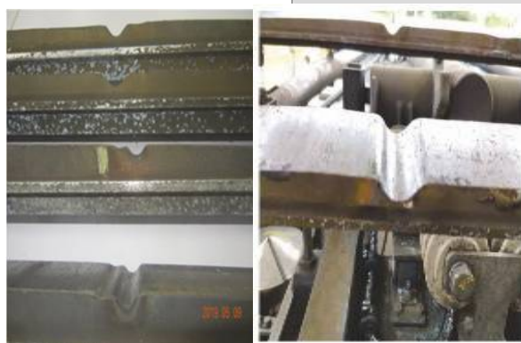
圖 3 集電弓碳刷單點過度磨耗
