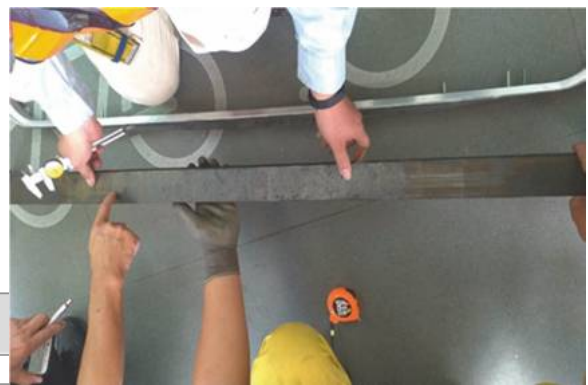
圖 4 集電弓過度磨耗導致耗材頻繁更換
