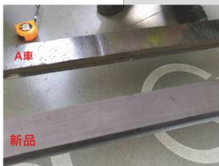
圖 13 重疊區間電車線偏位調整後新集電弓碳刷磨耗狀況
