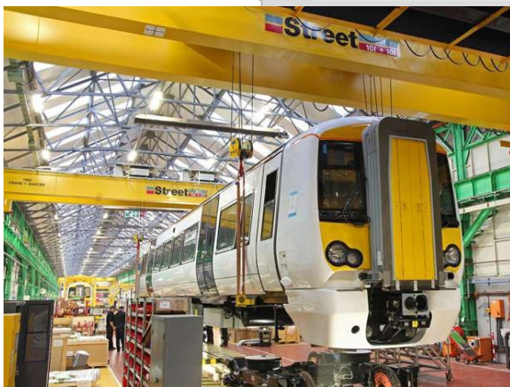
圖 5 架空式起重機吊運車廂
